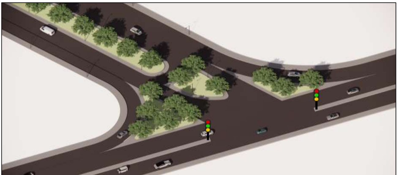
รูปที่ 7-7 รูปแบบทางแยกระดับดิน (At Grade) บริเวณจุดสิ้นสุดโครงการ
