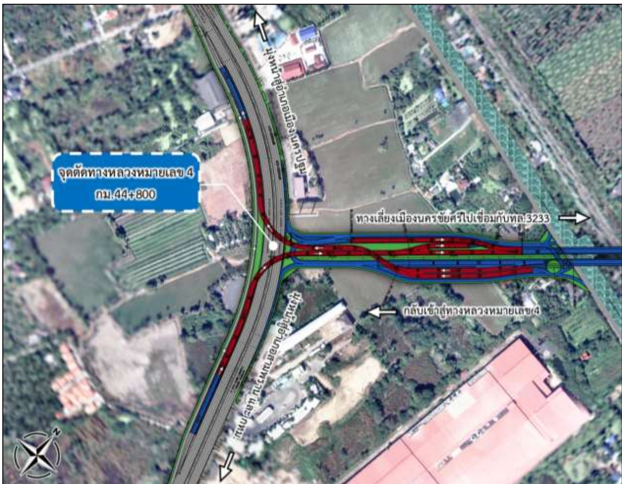
รูปที่ 7-6 Y Type (Y Interchange หรือ Directional Ramp) บริเวณชิดขอบทางเท้า
